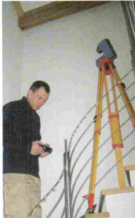
Gerade an engen Stellen ist es wichtig, dass der vertikale „Messschatten“ möglichst gering ist.
